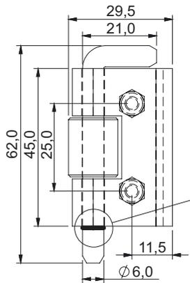
Após a montagem aplicar o anel o'ring para manter o pino preso durante o transporte
