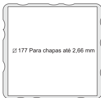
FURAÇÃO PARA MONTAGEM
