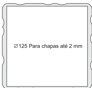
FURAÇÃO PARA MONTAGEM
