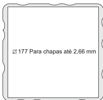
FURAÇÃO PARA MONTAGEM
